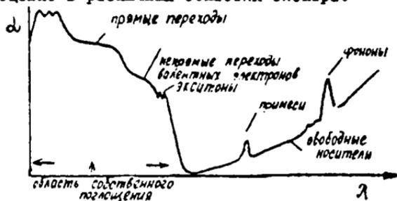
Рис. 2.1.2. Спектр поглощения реального полупроводника
