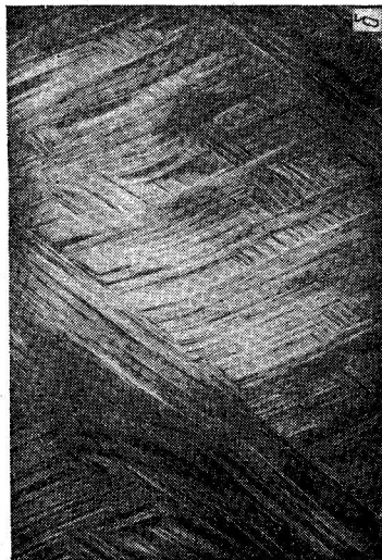
Рис. 25. Микрофотографии монокристалла I после удлинения ( \times 200 ): а — удлинение на 3%; б — удлинение на 14%.
