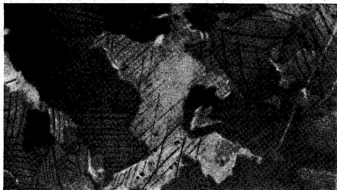
Рис. 34. Структура урана, остывавшего на воздухе из \beta -фазы. Электролитическая полировка. Поляризованный свет. \times 500 .
