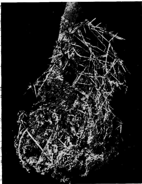
Рис. 157. Катодный осадок урана, на котором видны гроздья дендритообразных отдельных кристаллов.
