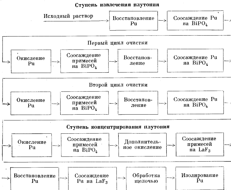
Рис. 28. Общая схема висмут-фосфатного процесса.
