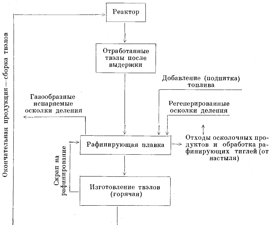
Рис. 33. Схема переработки отработанных твэлов окислительным шлакованием.
