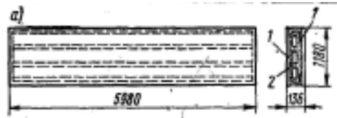
Рис. XII 1.5. Панели из асбестоцементных изделий:
