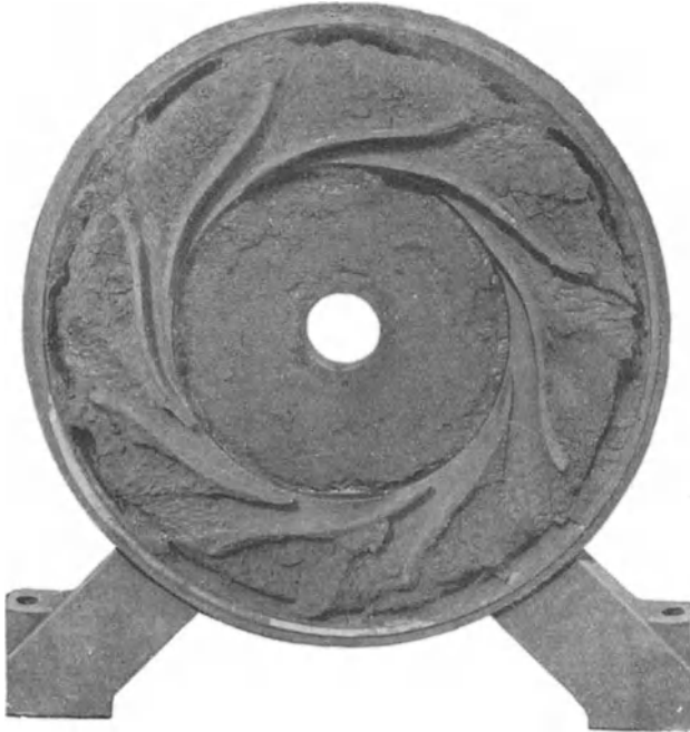
Abb. 81. Leitrad einer Pumpe mit stark erweiterten Kanälen, bei dem die eingetretene Strömung aus Schlammablagerungen ersichtlich ist.
