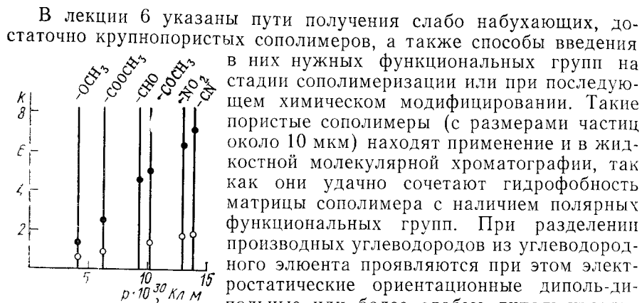
Рис. 16.15. Зависимость емкости колонн k , заполненных пористыми сополимерами, от электрического момента диполя p молекул дозируемого замещенного бензола. Колонны заполнены пористыми сополимерами эпоксиэтилметилакрилата с этилендиметилакрилатом (черные точки) и стирола с дивинилбензолом (белые точки). Элюент n -гексан, t = 26^\circ\text{C} .
