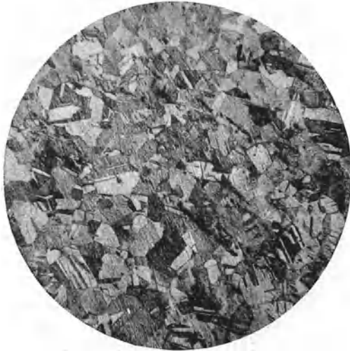
Abb. 1. Bronze draht von Kasing ( \times 100 ) Längsschliff.
