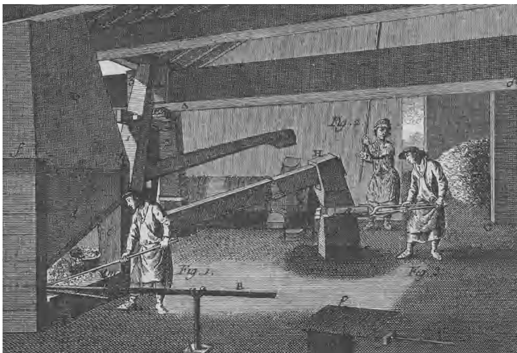
Abb. 39. Hammerwerk nach Art von Polhem und Kinman. (Nach einem Stiche des 18. Jahrh.)
