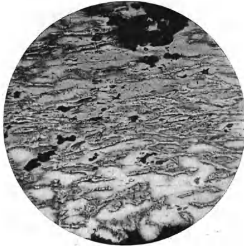
Abb. 2. Bronzeband ( \times 100 ) Längsschliff.
