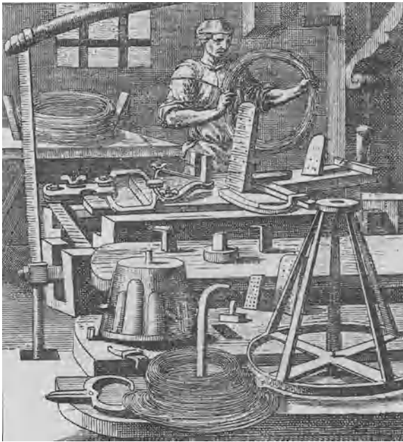
Abb. 28. Drahtzieherei des Jahres 1698. (Nach dem bekannten Stiche von Chr. Weigel.)
