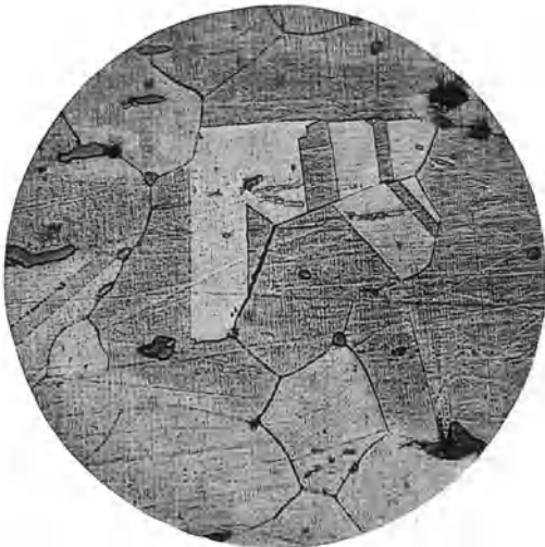
Abb. 6. Drahtstück von Thalmäßig ( \times 100 ) Längsschliff, geätzt.
