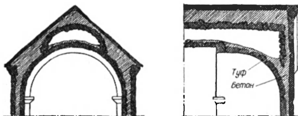
Рис. 57. Полое пространство над сводом и конхой
