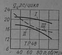
Рис. 71. Экспериментальные характеристики подачи топливной аппаратуры двигателя Бурмейстер и Вайн 62WF140 с золотниковым ТНВД, регулируемым по концу подачи:
