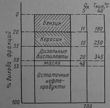
Рис. 118. Выход нефтепродуктов при прямой перегонке нефти:
