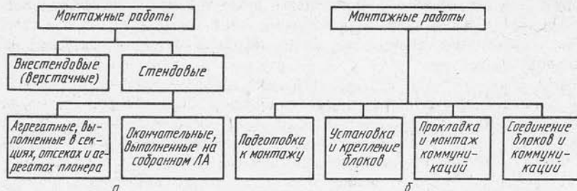
Рис. 2. 1. Классификация монтажных работ по месту выполнения (а) и по содержанию (б)
