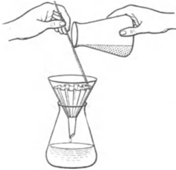
Abb. 17. Haltung eines Glasstabes beim Filtrieren.
