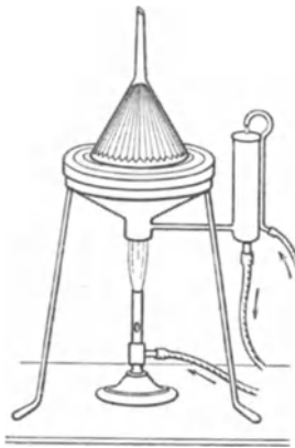
Abb. 15. Erwärmen von Trichter mit Filter auf dem Warmbade.
