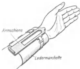
Abb. 162. Manschette mit Schiene für den Sphygmographen.
