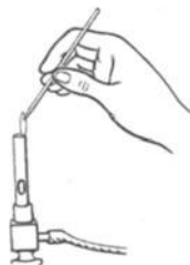
Abb. 35. Zuschmelzen des Schmelzpunktröhrchens.
