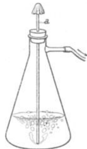
Abb. 88. Entfernung von Schwefelwasserstoff durch Durchsaugen von Luft.
