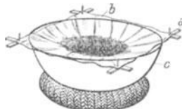
Abb. 79. Filtration durch Koliertuch auf Filtrierrahmen.
