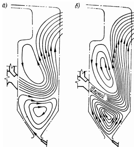
Рис. 2-1. Линии тока в вихревой топочной камере котла БКЗ-75-39 при \frac{(m\omega)_г}{(m\omega)_{н.д}} = 0,8 (а) и \frac{(m\omega)_г}{(m\omega)_{н.д}} = 1,8 (б)
