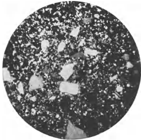
Abb. 23. Granulöses Quarzzement ohne Basalzement; Vergr. 25mal; + Nicols (nach v. Freyberg: a. a. O., S. 215)
