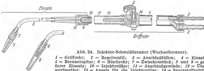
Abb. 24. Injektor-Schweißbrenner (Wechselbrenner).
