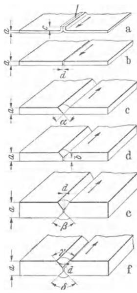
Abb. 29. Vorbereitungsarbeiten bei Blechschweißungen.
