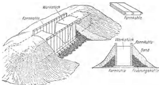
Abb. 51. Vorbereitung der elektrischen Warmschweißung.
