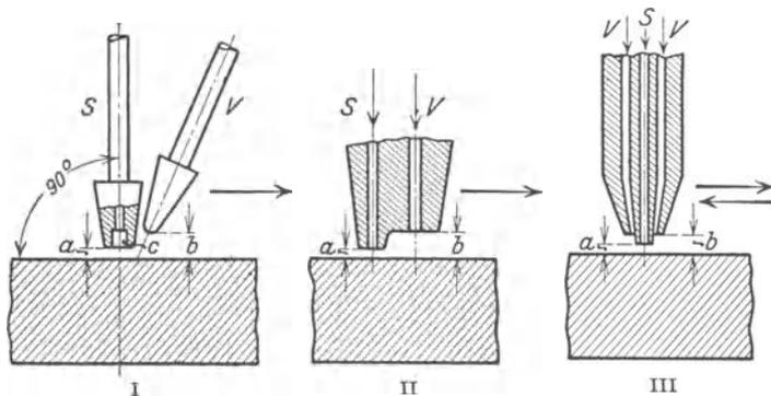
Abb. 60. Düsenlage und Düsenanordnung von Schneidbrennern.
