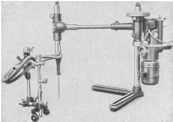
Abb. 62. Kreisschneidemaschine.
