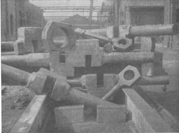
Abb. 64. Mit dem Schneidbrenner geschnittene Pleuelstangen und Kurbelwellen.
