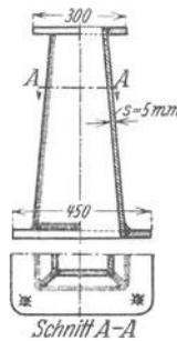
Abb. 41. Geschweißter Ständer einer Schleifmaschine.
