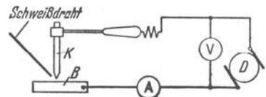
Abb. 4. Lichtbogenschweißanlage.
