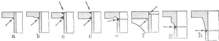
Abb. 38. Geschweißte Rohrflanschen.
