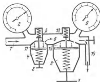
Abb. 15. Grundform eines zweistufigen hebellosen Druckminderventils.
