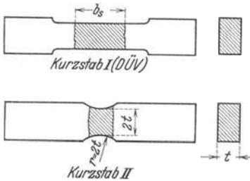
Abb. 69. Kurzstäbe für Zugversuche.
