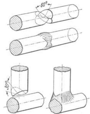
Abb. 44. Rundstahlschweißungen.
