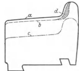
Abb. 48. Aufschiessen eines abgelaufenen Spurkranzes.
