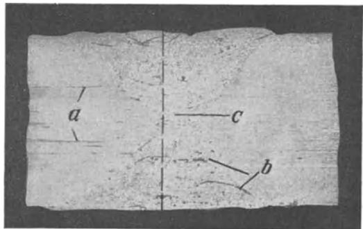
Abb. 73. Doppelseitig geschweißtes Flußstahlblech mit Schlackeneinschlüssen ( $v = 1$ ).
