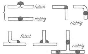
Abb. 58. Elektronschweißnähte.
