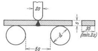
Abb. 70. Abmessungen für den Biegeversuch.
