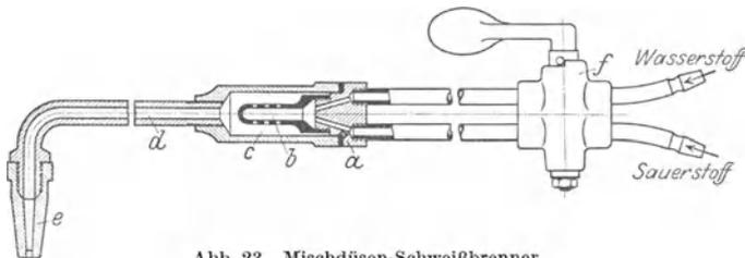
Abb. 23. Mischdüsen-Schweißbrenner.
