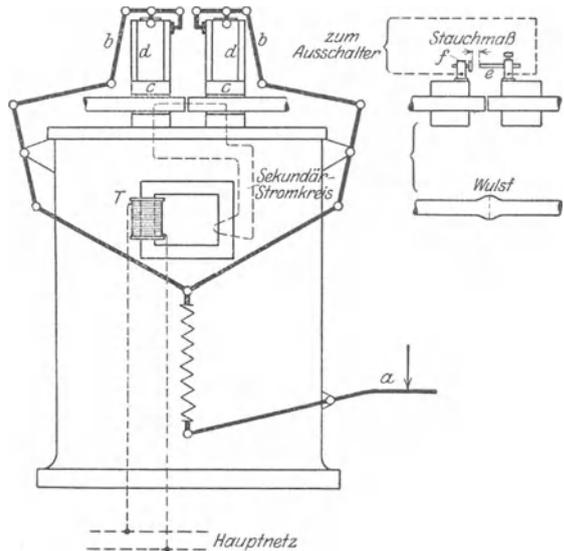
Abb. 9. Stumpfschweißmaschine.
