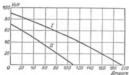
Abb. 6. Kennlinien eines Schweißumformers.
