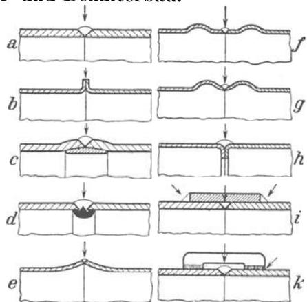
Abb. 36. Geschweißte Rohrrundnähte.
