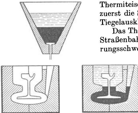
Abb. 3. Schienen-schweißung mit Thermit.
