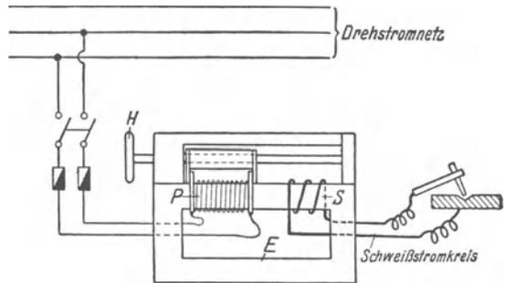
Abb. 7. Grundform eines Wechselstrom-Schweißumspanners.
