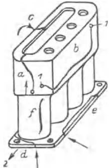
Abb. 53. Gasschweißungen an einem Autoblockzylinder.
