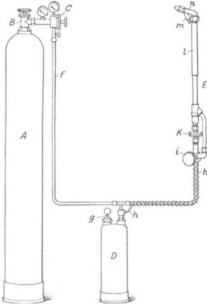
Abb. 26. Benzol-Schweißeinrichtung.
