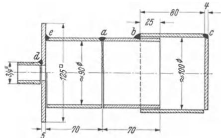
Abb. 71. Geschweißter Rohrkörper.
