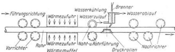
Abb. 39. Rohrschweißmaschine.
