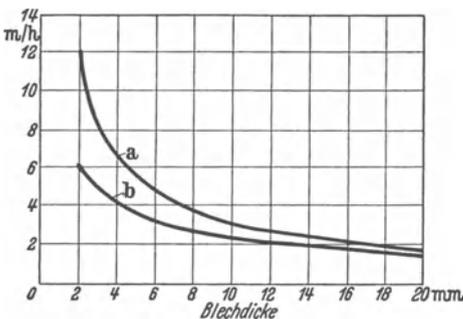
Abb. 77. Schweißgeschwindigkeiten bei Kupferblech (a) und Aluminiumblech (b).
