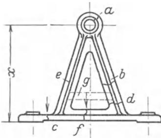
Abb. 52. Gasschweißungen an einem Lagerbock.
