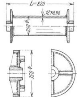
Abb. 42. Geschweißte Teile einer Bockwinde.
