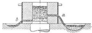
Abb. 1. Anschweißen eines Walzenzapfens.
