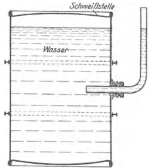
Abb. 47. Schweißung eines Benzinfassens.
