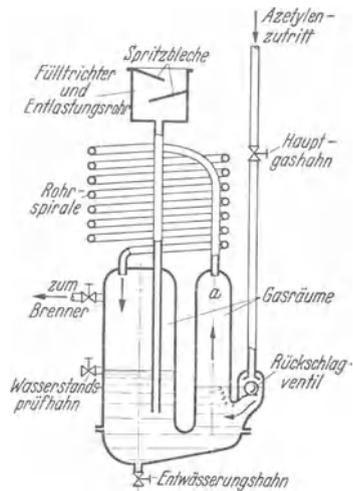
Abb. 22. Wasservorlage.
