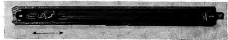
Фиг. 7. Тепловая труба № 4 после 3 час работы при температуре 1600 °С (нижняя половина).
