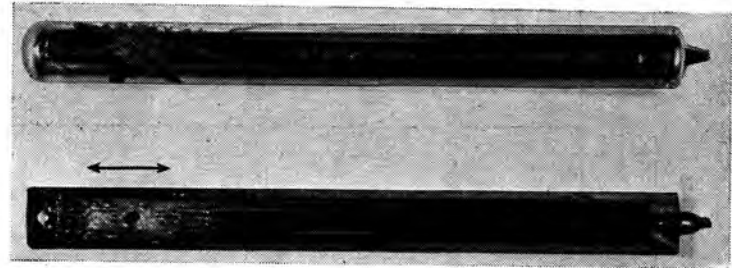
Фиг. 6. Тепловая труба № 3 после 42 час работы при температуре 1500 °С (нижняя половина).
