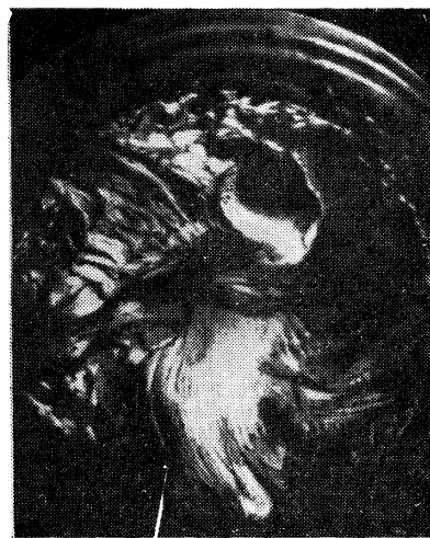
Рис. II.18. Поверхность разрыва цилиндрического стеклянного образца [233] (комнатная температура, скорость деформации 0,1667 м/с).
