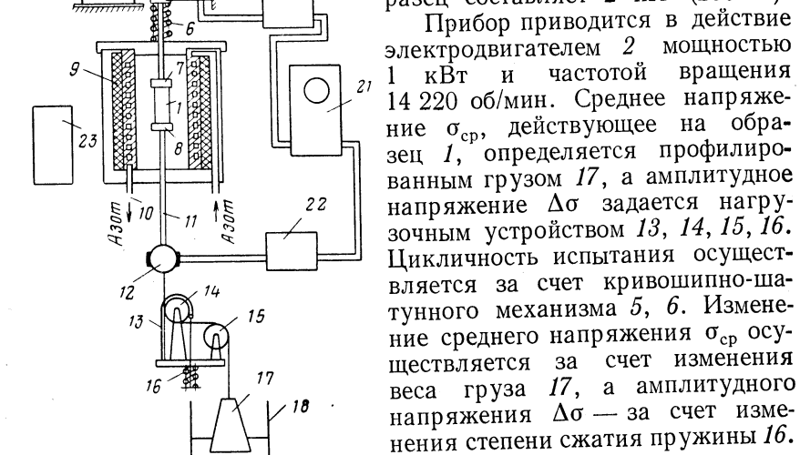
Рис. 1.16. Схема установки для циклических испытаний в режимах \sigma_{\text{макс}} = \text{const} , \Delta\sigma_{\text{макс}} = \text{const} :
