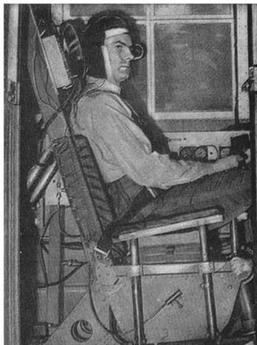
Камера центрифуги в Фарнборо, в которой исследуют, как человек переносит большие ускорения. Дыхание, кровяное давление, пульс, функционирование сердца и мозга записываются с помощью датчиков
