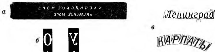
Рис. 58. Фотонаборная верстатка (а), фотонаборная литера (б), вырезание фотонаборной наклейки (в)
