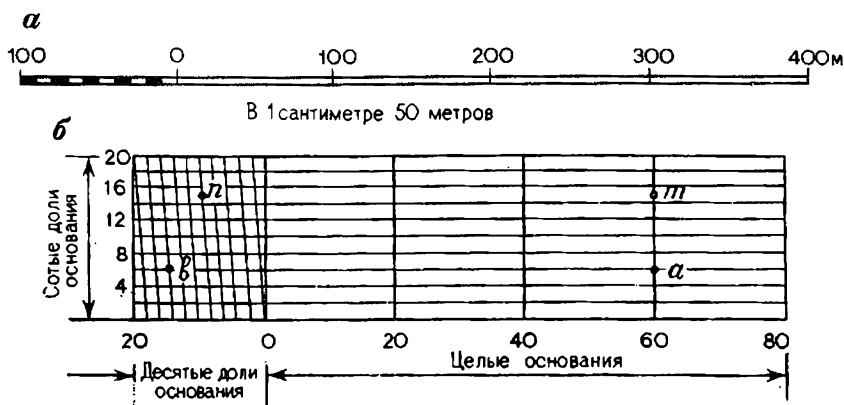
Рис. 21. Линейный (а) и поперечный (б) масштабы
