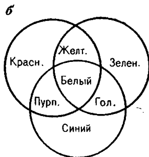
Рис. 89. Кривая взаимно дополнительных цветов спектра (а), принципиальная схема аддитивного смешения цветов (б)
