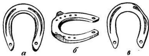
Рис. 9. Подковы: а) передняя; б) задняя; в) передняя подкова для за- секающихся лошадей
