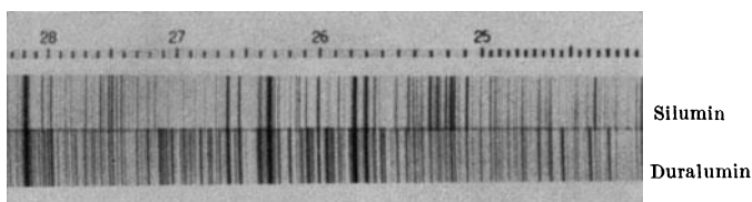
Abb. 25. Aluminium-Legierungen mit der Stufenblende aufgenommen.
