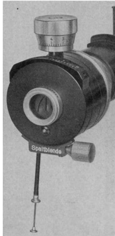
Abb. 24. Spaltkopf mit eingekapselter Stufen- und Keilblende (FUSS):
