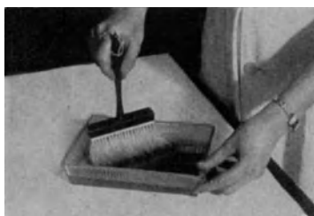
Abb. 62. Pinselentwicklung. Der Pinsel wird zur Vermeidung von Wellen etwas schräg geführt.
