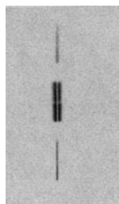
Abb. 34. Selbstumkehr von Zn 2138,5; Pb + 1% Zn, Zn rein, Pb + 0,1 % Zn.
