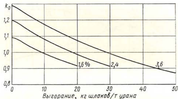
Рис. 2.6. Зависимость асимптотического коэффициента размножения нейтронов от выгорания при различном обогащении топлива ВВЭР-440
