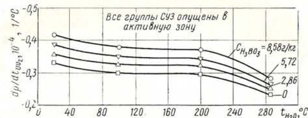
Рис. 3.4. Зависимость коэффициента реактивности по температуре топлива от температуры теплоносителя для ВВЭР IV блока НВАЭС
