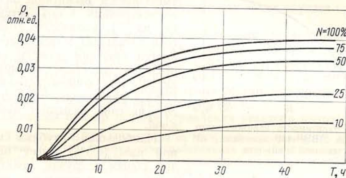
Рис. 4.4. Стационарное отравление ВВЭР-440 ксеноном
