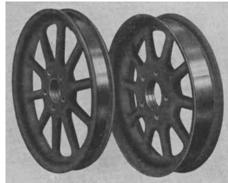
Abb. 420. Speichenrad, aus Stahlblech gespreßt, geschweißt (Hering).
