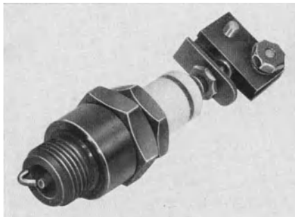
Abb. 467. Zündkerzenthermoelement, Mittelstift ist durchbohrt und mit Nickel-Nickelchroelement versehen.
