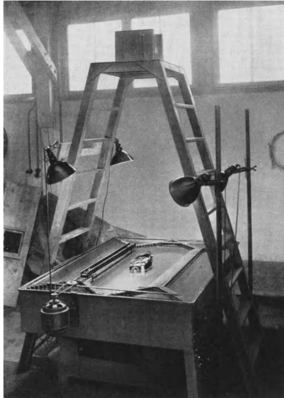
Abb. 478. Fahrzeugmodell im Wasserkanal. (Der Elektromotor dient zum Antrieb der Schrauben für die Wasserbewegung und eines die Fahrstraße nachahmenden Laufbandes.) (FKFS.)
