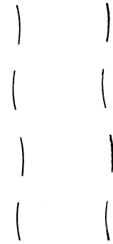
Abb. 228. Radspur beim Tanzen (Shimmy).
