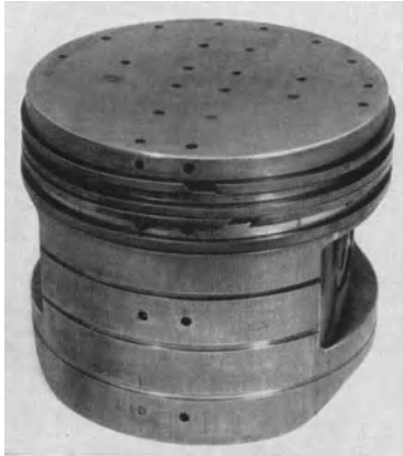
Abb. 470. Motorkolben mit Anbohrungen zum Einpfropfen von Schmelzkegeln.
