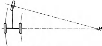
Abb. 200. Einradlenkung beim Dreiradfahrzeug
