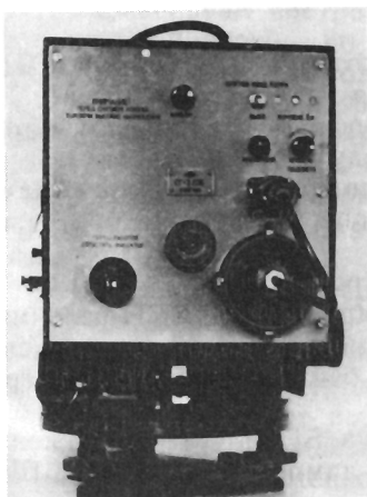
Рис. 18. Исходные положения органов управления на блоках светодальномера СГ-3 (слева — приемно-передающий блок, справа — счетчик, блок управления и блок питания)
