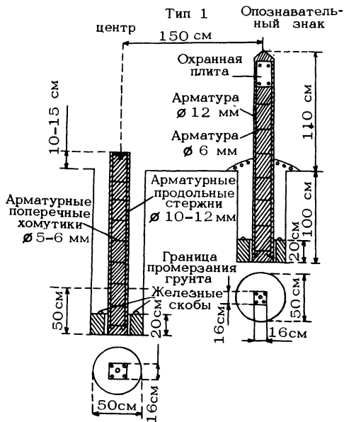
Рис. 57. Пилонный центр для области сезонного промерзания грунта
