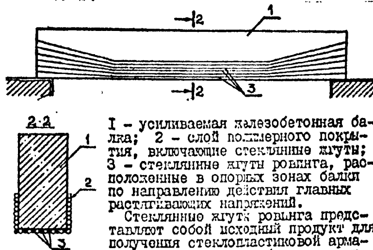
НАНЕСЕНИЕ ПОЛИМЕРНОГО ПОКРЫТИЯ, ВКЛЮЧАЮЩЕГО СТЕКЛЯННЫЕ ЖГУТЫ (А.с. №1470911)
