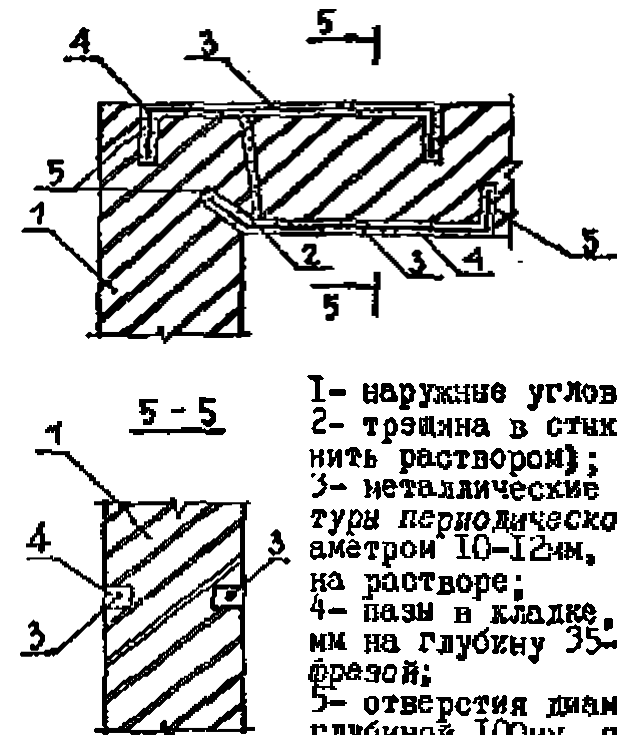
СОЕДИНЕНИЕ УГЛОВЫХ НАРУЖНЫХ СТЕН СТАЛЬНЫМИ СКОБАМИ
