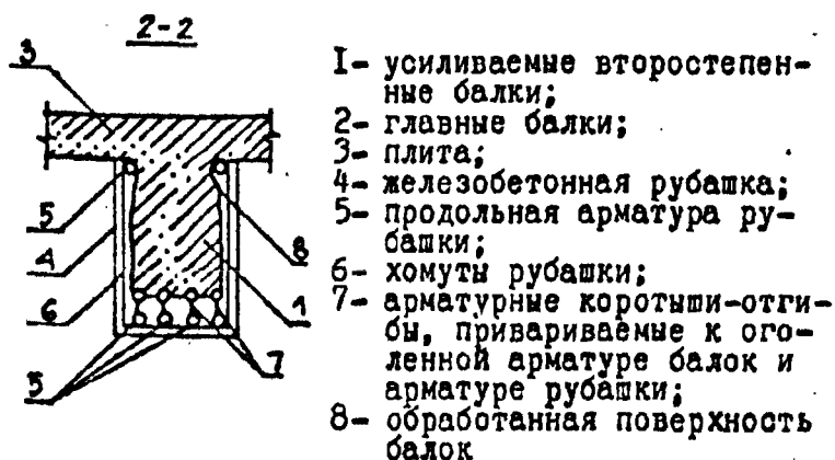
УСТАНОВКА СТЯГИВАЕМЫХ ПОПЕРЕЧНЫХ СТЕРЖНЕЙ У ОПОР
