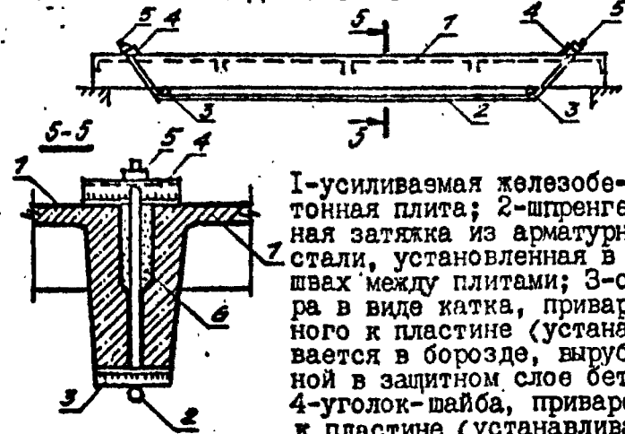
УСТАНОВКА ШПРЕНГЕЛЬНЫХ ЗАТЯЖЕК В ШВАХ МЕЖДУ ПЛИТАМИ
