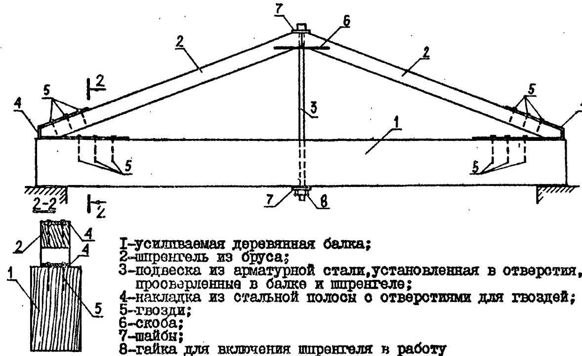
УСТАНОВКА ШПРЕНГЕЛЯ В ВИДЕ ТРЕУГОЛЬНОЙ ФЕРМЫ
