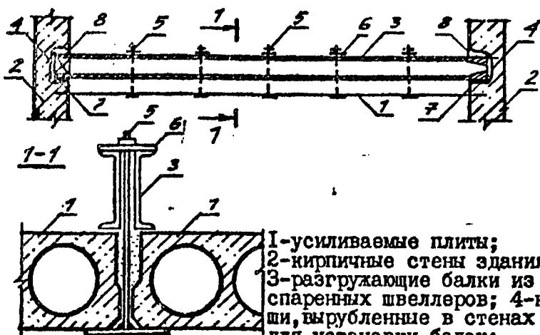
ПОДВЕДЕНИЕ РАЗГРУЖАЮЩИХ МЕТАЛЛИЧЕСКИХ БАЛОК (СВЕРХУ)
