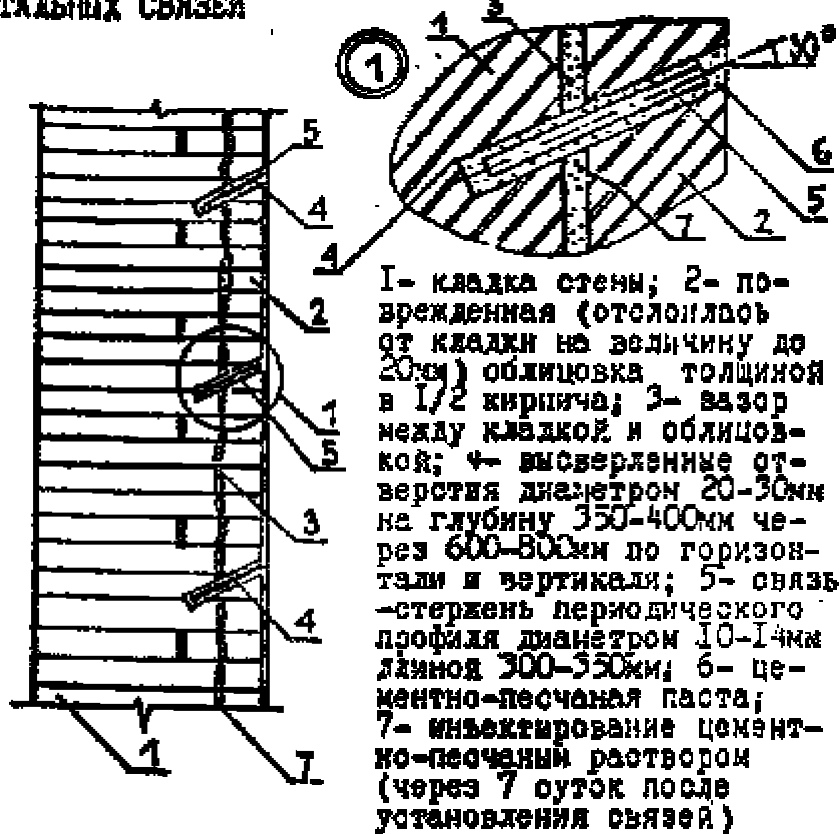
ВОССТАНОВЛЕНИЕ РАЗРУШЕННЫХ НАРУЖНЫХ УЧАСТКОВ СТЕН УСТРОЙСТВОМ ОБЛИЦОВОК С УСТАНОВКОЙ СТАЛЬНЫХ СВЯЗЕЙ
