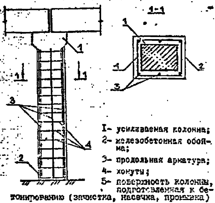
УСТРОЙСТВО ЖЕЛЕЗОБЕТОННОЙ ОБОЙКИ С КОСВЕННЫМ АР.УРОВНЯНИЕМ
