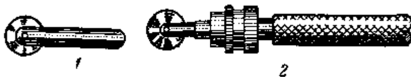
Рис. 134. Зенкер для раззенковки отверстий:
