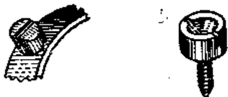
Рис. 92. Облегчение винтов баланса: 1 метод опилочки; 2 метод зенковки
