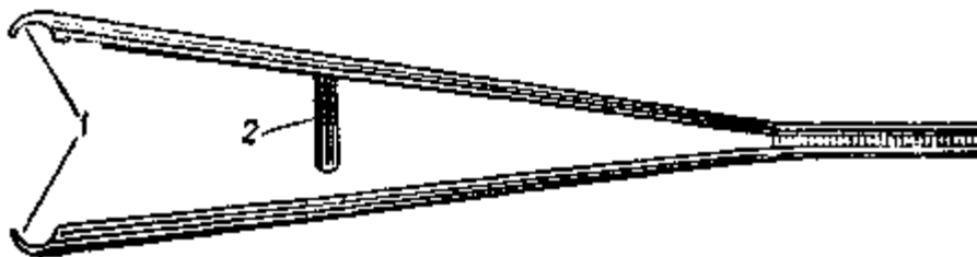
Рис. 58. Пинцет для шлифовки и полировки винтов:
