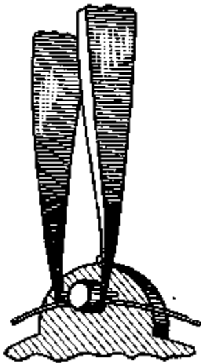
Рис. 73. Закрепление волоска в колодке
