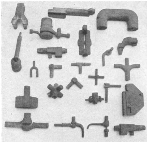
Abb. 83. Mit der Druckluft-Kernspritze (Abb. 82) hergestellte Kerne.
