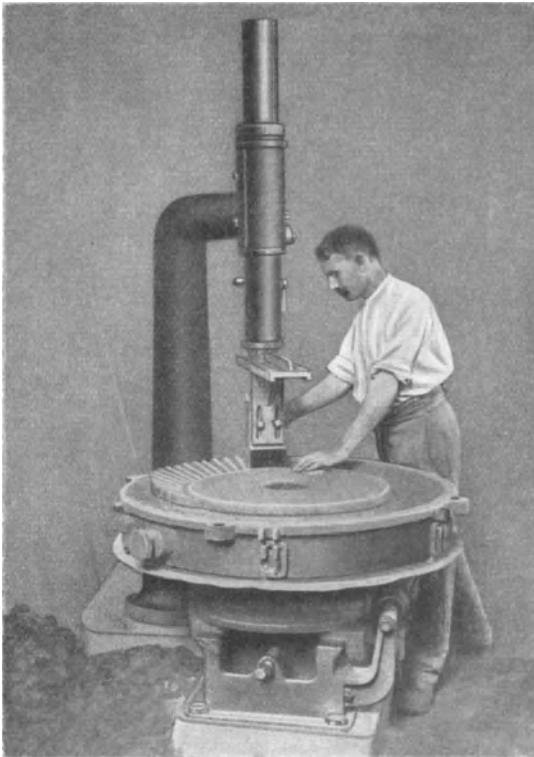
Abb. 68. Tisch-Zahnradformmaschine (Badische Maschinenfabrik, Durlach).
