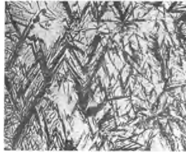
Abb. 21. Stahl mit 0,8% C von 900° abgeschreckt. Martensit. (Vergr. 750 \times .)
