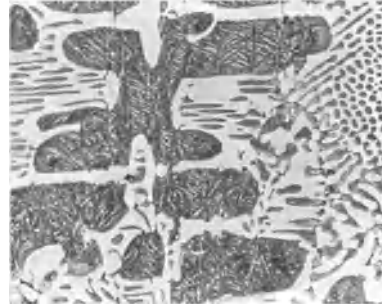
Abb. 15. Roheisen mit 3,6% C . Ledeburit und Mischkristalle. (Vergr. 200 \times )
