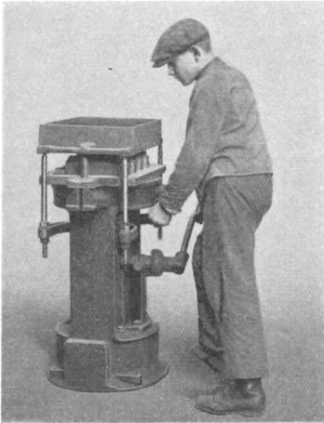
Abb. 51. Einfache Abhebeformmaschine (Badische Maschinenfabrik, Durlach).
