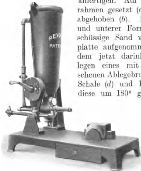
Abb. 82. Druckluft-Kernspritze „Revolt“ (Maschinenfabrik Gustav Zimmermann, Düsseldorf-Rath).
