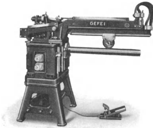
Abb. 219. Längsnaht-Schweißmaschine (Gesellschaft für elektrotechnische Industrie m. b. H., Berlin).
