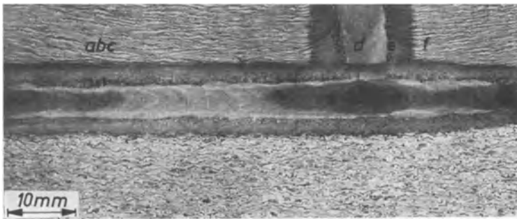
Abb. 85. Abschnitt 5 (Längsschnitt) aus der Halsnaht der Zugzone des Trägers 8. Zustand, nachdem seitlich 7,5 mm abgehobelt waren. In der Übergangzone zum Stegblech sind 6 Risse a bis f sichtbar.
