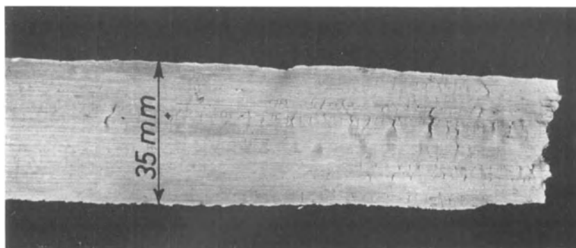
Abb. 117. Zustand der Wulstfläche der in Abb. 116 dargestellten Probe nach dem Biegeversuch. Rechts liegt die in Abb. 116 abgebildete Bruchfläche.
