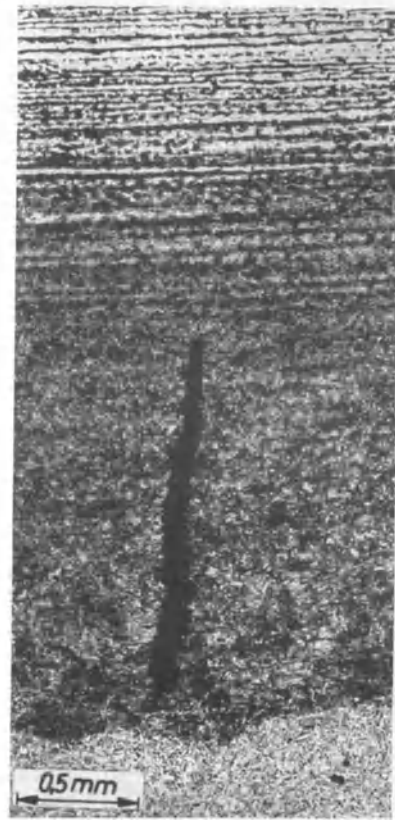
Abb. 115. Querriß im Übergang der Halsnaht zum Gurt in der Probe 2 D 5, Abb. 101 links oben.
