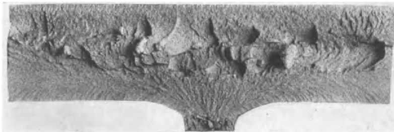
Abb. 116. Bruchfläche der Probe 3 Z 2 nach dem Faltversuch. Der Wulst lag in der Zugzone.
