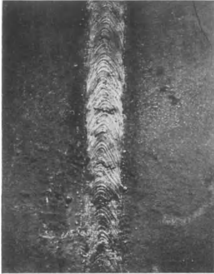
Abb. 132. Probe 4,15 aus St 52 PSb, 50 mm dick. Schweißung bei rd. 400°. Probekörper nach dem Versuch; bleibender Biegewinkel 97°.
