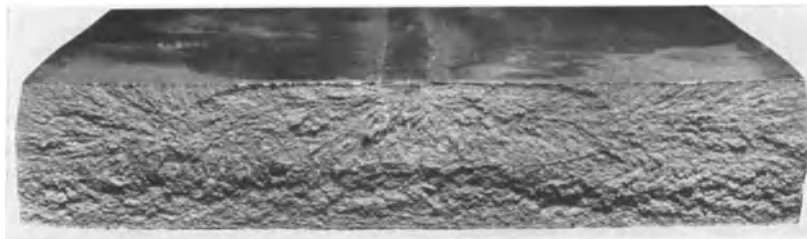
Abb. 133. Probe 1,1 aus St 52 DSb, 50 mm dick. Schweißung bei rd. 20°. Bruchfläche des Probekörpers; bleibender Biegewinkel 7°.
