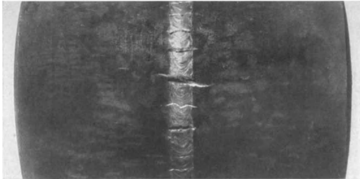
Abb. 122. Probe 11,9 aus St 52 Dsb, gegläht, 30 mm dick, Schweißung bei rd. 20°. Der erste Anriß ist nach einem bleibenden Biege Winkel von 22° beobachtet worden. Am Schluß des Versuchs betrug der Biege Winkel 121°. Das Bild zeigt den Zustand am Schluß des Versuchs.
