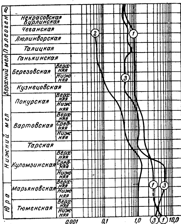
Рис. 43. Графики изменения некоторых свойств рассеянного органического вещества и битумов по разрезу кайнозойских и мезозойских отложений Западно-Сибирской низменности. Составил И. И. Нестеров, 1962 г.
