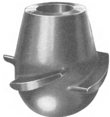
Abb. 175. Bohrlochpropeller für kleine flache Bohrlöcher.
