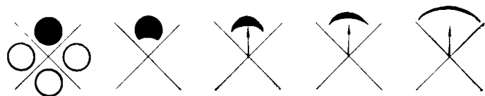
Рис. 3.4. Схематическое изображение последовательных стадий предварительного разделения проб, нанесенных вокруг центра пластинки (эксцентрически).
