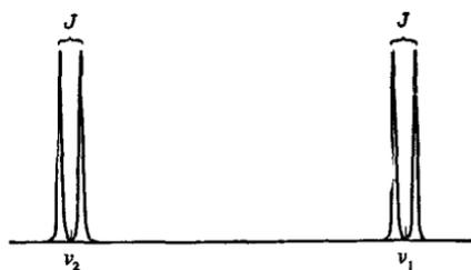
Рис. 19 Спин-спиновое взаимодействие между двумя протонами с сильно различающимися химическими сдвигами.
