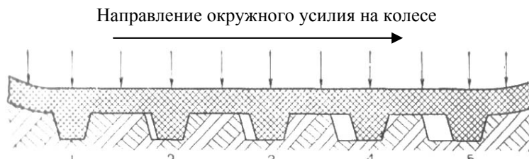
Рис. 10. Схема влияния времени нахождения грунтозацепов в контакте с грунтом на величину передаваемой ими тяги
