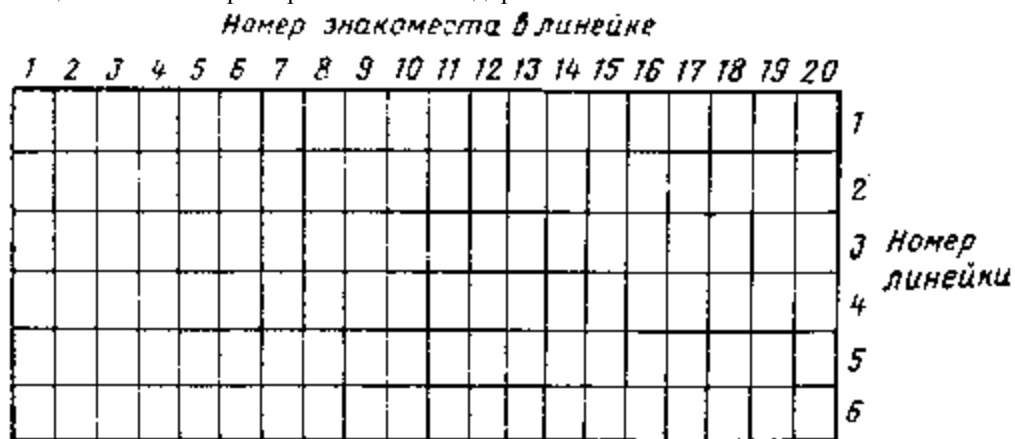
Рис. 4.12. Размещение индикаторов на информационном поле в шесть строк по двадцать индикаторов в каждой
