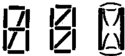
Рис. 3.2. Структурные рисунки индикаторов, наиболее перспективных с точки зрения помехоустойчивости
