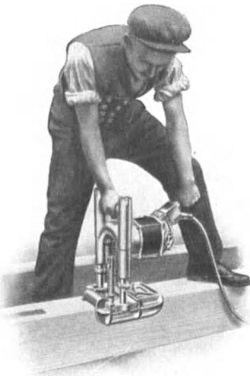
Abb. 71. Elektrischer Handkettenstempapparat, zum Zapfenlochstemmen eingerichtet, Bauart Schmaltz. Fräskette mit unten runder Führung; vgl. Abb. 68, 69.
