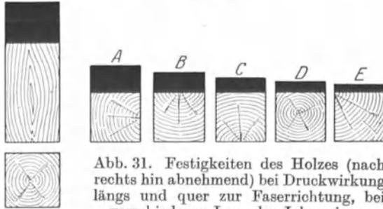
Abb. 31. Festigkeiten des Holzes (nach rechts hin abnehmend) bei Druckwirkung längs und quer zur Faserrichtung, bei verschiedener Lage der Jahresringe.
