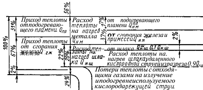
Рис. 91. Тепловой баланс газовой резки стали толщиной 15 мм
