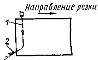
Рис. 127. Непрорезание металла по толщине в начале резки:
