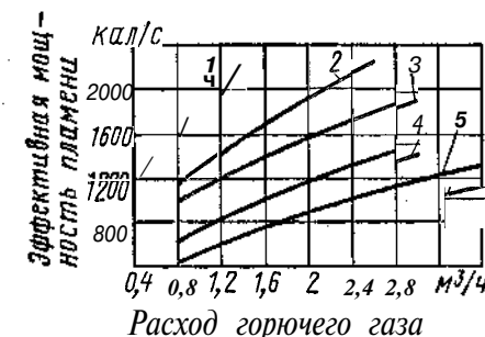
Рис. 8. Зависимость эффективной мощности пламени от расхода горючего газа:
