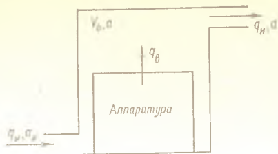
Рис. 4.25. Схема продувки кузова с аппаратурой
