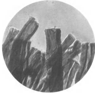
Abb. 15. Quellprobe einer schwer geschädigten Baumwolle.
