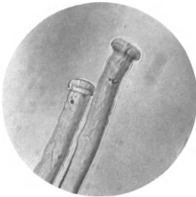
Abb. 14. Quellprobe der ungeschädigten Baumwollfaser.
