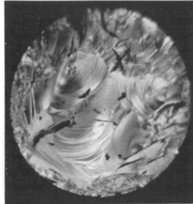
Abb. 20. Muschelige Zerreifläche eines in Raumtemperatur zerrissenen Glasstbchens (40fache Vergrößerung). (G. APELT.)
