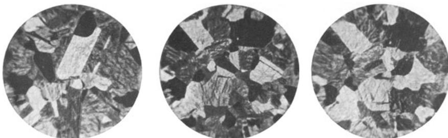
Abb. 34. Eisenumkristallisation (Sprungverfahren  $V = 60$ ). [BRÜCHE und KNECHT (29)]
