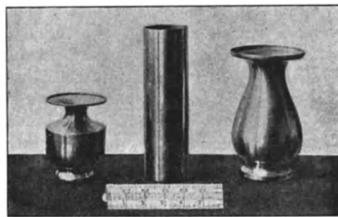
Fig. 23. Gefäße aus Bessemerblechscheiben von 11 Zoll engl. Durchmesser und \frac{1}{16} Zoll engl. Stärke durch Drucken auf der Drehbank hergestellt.
