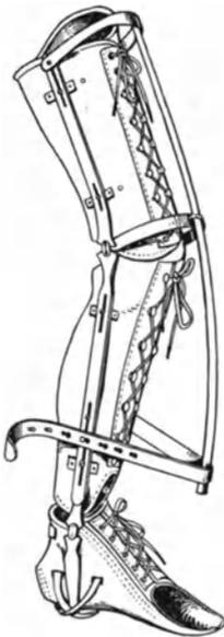
Abb. 78. *HESSINGES* Schienenh hlenapparat zur Streckung von Beugekontrakturen des Kniegelenkes.
