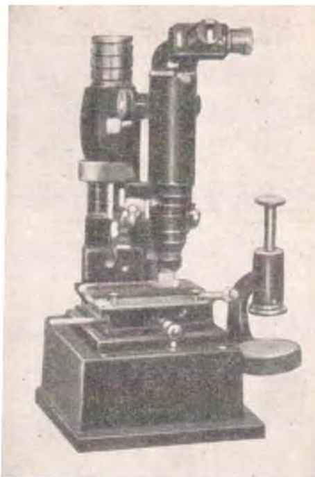
Рис. 162. Аппарат для определения микро-твердости.
