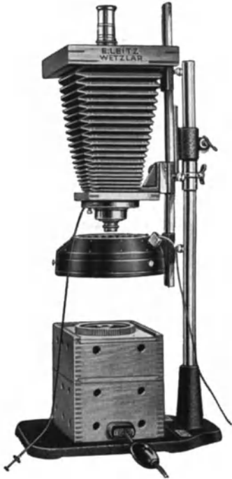
Abb. 39/1. Makrophotographisches Aufnahme-gerät von Leitz-Wetzlar mit oberer Ringbeleuchtung und beleuchteter Auflagefläche.
