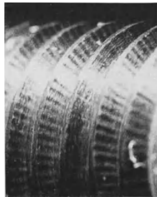
Abb. 59/4. Geschliffene Schraubenfläche, nachträglich angeläpft. Die Rattermarken sind durch das Anläppen als helle Stellen sichtbar geworden. Vergr. 2\times .
