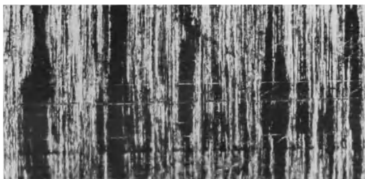
Abb. 239/2. Bolzen (Abb. 239/1) nach dem Einpressen und Wiederauspressen. Die schwarzen Tragflächen entsprechen dem Vorschub des Schlichtspanes. Vergr. 115\times .
