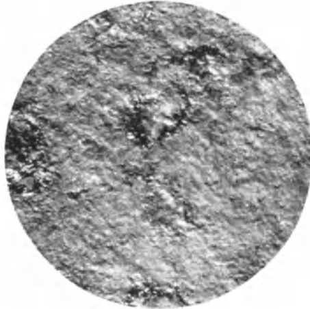
Abb. 66a. Gußeisen; Os ; V = 20 \times .
