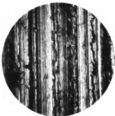
Abb. 40a. Gußeisen; Os; V = 41\times .
