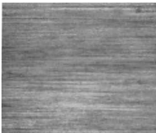
Abb. 167/4a und b. a Reinaluminium hartgewalzt (etwa 90 % Verformung), nahezu reine Faserstruktur (geätzt Flußsäure + HCl). Vergr. 2×. b Reinaluminium nach dem harten Walzen gegläht, rekristallisiert. Sonst wie a.
