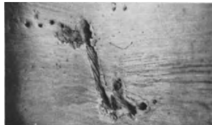
Abb. 223/3. Zerstörung durch Stromübergang an einer Wälzlagerrolle. Vergr. 10x.
