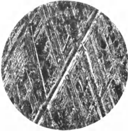
Abb. 54a. Gußeisen; Os ; V = 76\times .
