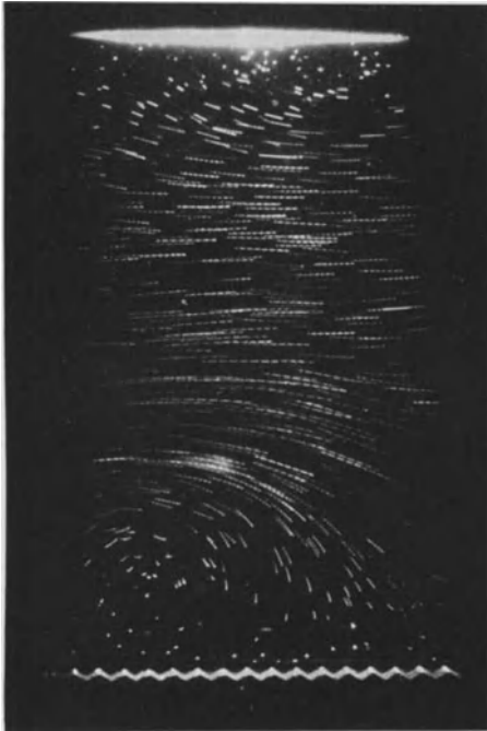
Abb. 244/1. Strömung zwischen zwei Wänden, aufgenommen nach dem Lichtschnittverfahren. Vergr. 2\times . Mittlere Strömungsgeschwindigkeit 0,14 cm/sec, 7,9 Unterbrechungen/sec.
