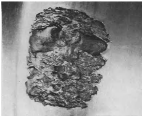
Abb. 221/1. Abgeblätterte Stelle an einem Schräglagerinnenring (typischer Ermüdungsbruch). Vergr. 8\times .
