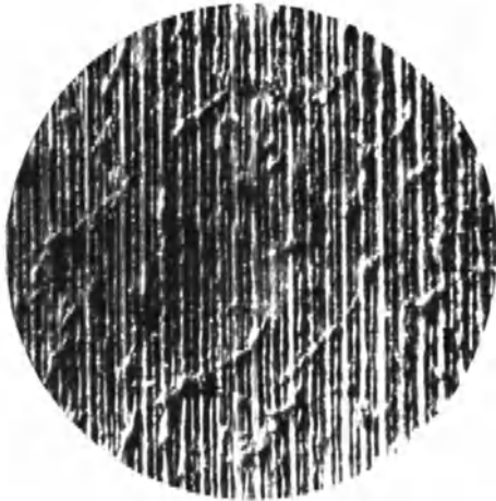
Abb. 47a. Gußeisen; Os ; V = 82 \times .
