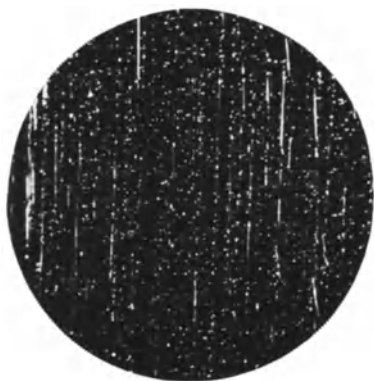
Abb. 101/1. (Z 1) Endmaßfläche von sehr hoher Güte. Vergr. 100 \times . J = 0,05 , G \geq 2000 .
