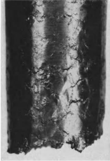
Abb. 170/1. Fein verteilte Anrisse eines Zugstabes aus Bronze als Beispiel stofflicher Inhomogenität. Vergr. 2×. (Nach KUNTZE.)
