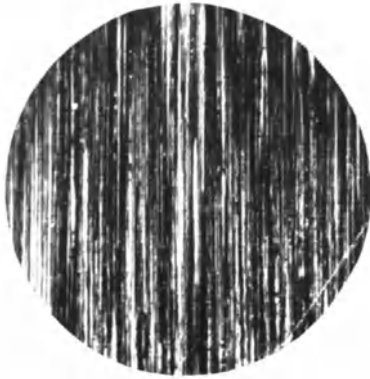
Abb. 95/1. Meßfläche, fein geschliffen, Stahl, Probe L 2. Dunkelfeldaufnahme. Vergr. 100 \times .
