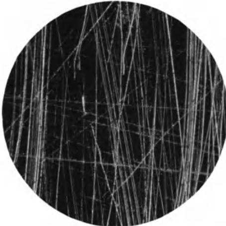
Abb. 46/3. Stahl poliert, mit Epilampe von rechts beleuchtet. Vergr. 71×. Einfluß des Azimutes.
