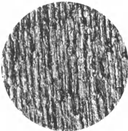
Abb. 5 a. Gußeisen; Os ; V = 20 \times .
