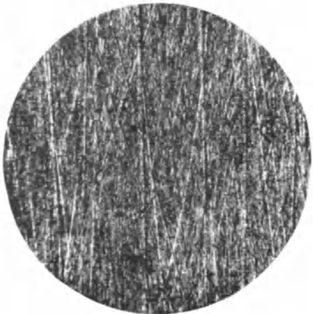
Abb. 51a. Gußeisen; Os ; V = 82\times .
