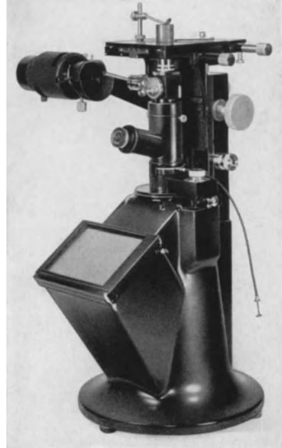
Abb. 49/1. Mikroskopisches Universalgerät (Metaphot) der Firma Emil Busch AG.-Rathenow .
