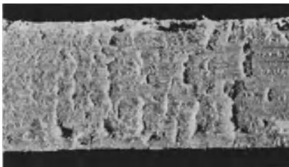
Abb. 130/2. Bearbeitete Oberfläche St. 42.11. v = 25 m/min; t = 0,33 mm/Uml.; b = 2,5 mm. Vergr. 10\times .
