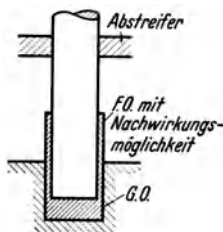
Abb. 164/4. Halbfreie und gebundene Oberflächen beim Kaltspritzen.
