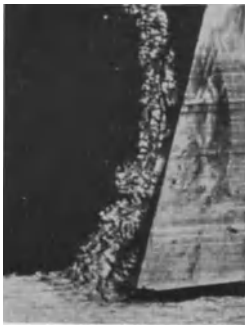
Abb. 138/1. Aufbauschneide oder Schneidenansatz. v = 22,5 \text{ m/min} ; t = 0,4 \text{ mm/Uml.} ; \gamma = 10^\circ . Vergr. 3\times .
