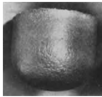
Abb. 167/2. Oberfläche von grobkörnigem Aluminiumblech beim Tiefziehen. (Nach SACHS.)
