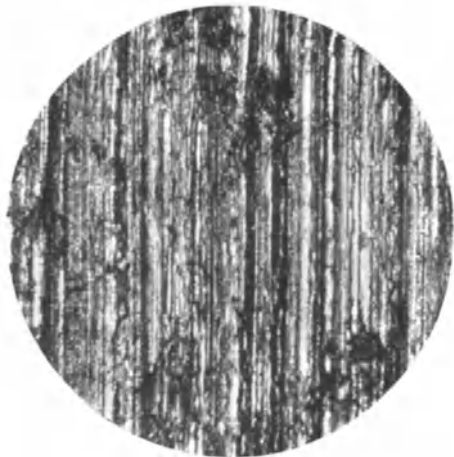
Abb. 50a. Gußeisen; Os ; V = 82\times .
