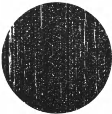
Abb. 94/1. Endmaßfläche von sehr hoher Güte, Probe Z 1. Dunkelfeldaufnahme. Vergr. 100 \times .
