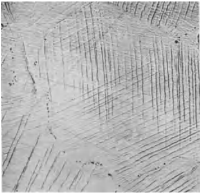
Abb. 168/1. Gleitlinien auf der Oberfläche eines gestauchten, polierten Kupferkörpers (gegossen). Vergr. 160 \times . Ungeätzt.
