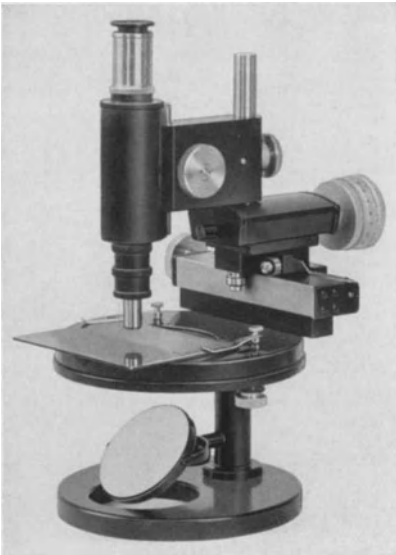
Abb. 80/1. Kreuzschlittenmikroskop zur Ausmessung der Oberflächenprofilbilder (Carl Zeiss-Jena).
