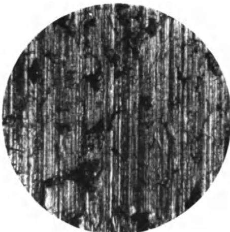
Abb. 34a. Gußeisen; Os ; V = 82 \times .
