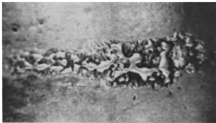
Abb. 223/2. Stromdurchgang als Überschlag an einer Wälzlagerrolle. Vergr. 10x.
