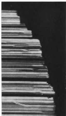
Abb. 16/1. Cd-Kristallschicht parallel der (001) Ebene. Vergr. 700×. (Nach STRAUMANIS.)
