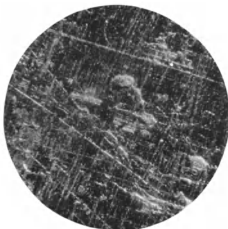
Abb. 37 a. Gußeisen; Os ; V = 82\times .
