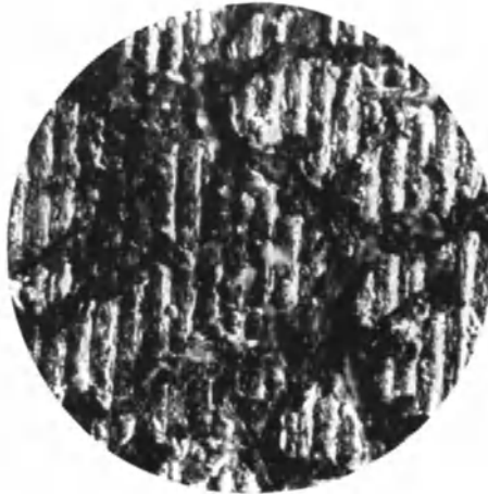
Abb. 73a. Cu-Al-Legierung; Os ; V = 170\times .
