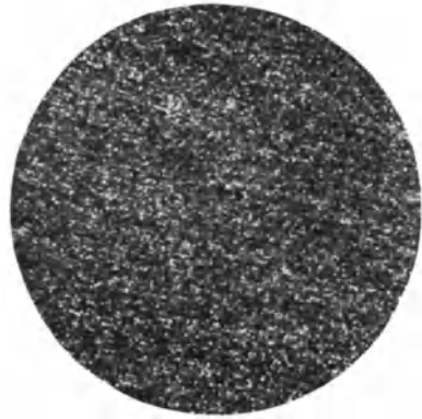
Abb. 157/1. Feinstgeläppte Endmaßfläche höchster Präzision. Vergr. 100\times .
