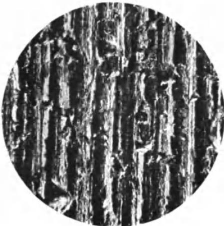
Abb. 31a. Gußeisen; Os ; V = 170 \times .
