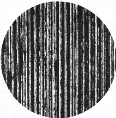
Abb. 95/4. Stahl mit Topscheibe geschliffen. Dunkelfeldaufnahme. Vergr. 78 \times .
