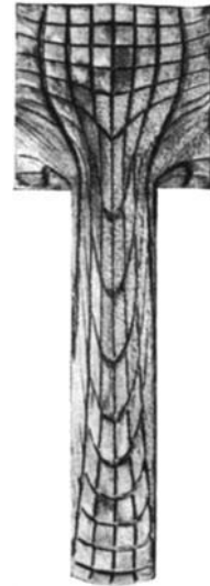
Abb. 163/1. Innere Fließspuren einer gepreßten Messingstange. (Nach SACHS.)
