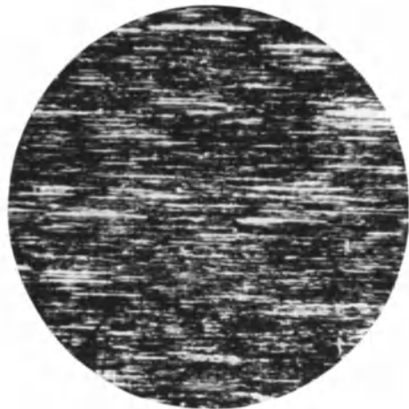
Abb. 155/3. Stahl 60 kg geschliffen und geläppt. Vergr. 82x.
