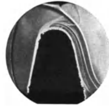
Abb. 257/1. Schlierenaufnahme eines elektrolytisch erzeugten Diffusions-schleiers vor einem Kupferkörper bei Strömung von links nach rechts als Modell für die Wärmeübertragung. (Nach Versuchen von SCHMALTZ.)
