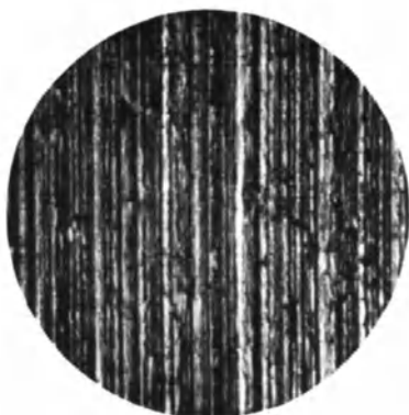
Abb. 42a. Gußeisen; Os; V = 41,5\times .
