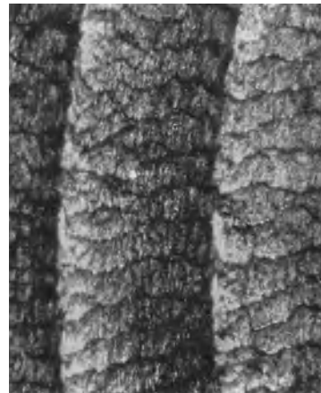
Abb. 131/4. Stahl plangedreht, Vergr. 23\times . Aufsicht, dieselbe Probe wie Abb. 131/3.
