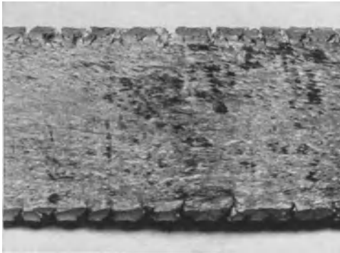
Abb. 164/3. Gewalzte Stange aus Zink mit übermäßig freier Verformung. Einfluß der Oberflächenbeschaffenheit der Walzen an der flachen Seite (gebundene Oberfläche), Einrisse an den Schmalseiten (freie Oberfläche).
