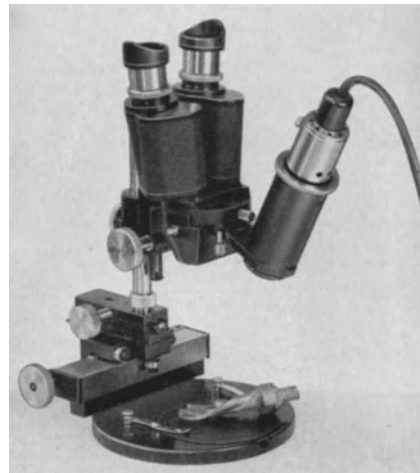
Abb. 51/2. Binokulare Lupe mit Beleuchtungslampe zur Betrachtung technischer Oberflächen, von Carl Zeiss-Jena .
