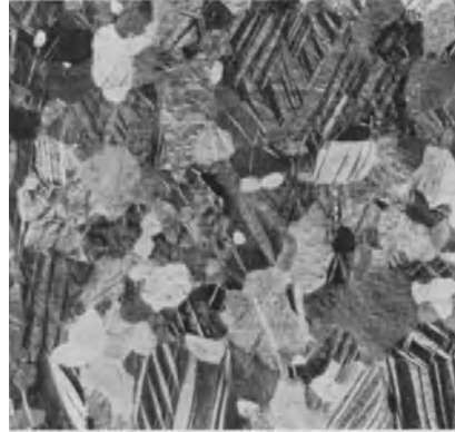
Abb. 168/2. Verformungszwillinge in Zink. Vergr. 8 \times . Geätzt mit konz. HCl + KClO 3 .
