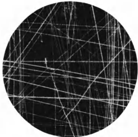
Abb. 46/2. Stahl poliert, aufgenommen mit Epikondensor, Dunkelfeldbeleuchtung. Vergr. 71×.
