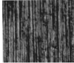
Abb. 155/1. Motorwelle geschliffen (amerikanische Fabrik). Vergr. 190x.
