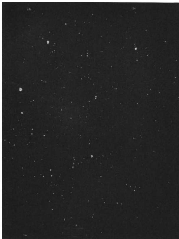
Abb. 158/1. Dunkelfeldaufnahme einer Endmaßfläche allerhöchster Güte. Die weißen Punkte sind Gasblasen im Werkstoff. Polierrisse sind nicht mehr vorhanden. Die Fläche ist so gut, daß sie wegen ihrer Empfindlichkeit gegen Verletzungen als Endmaßfläche praktisch nicht verwendet werden kann. Vergr. 100×.
