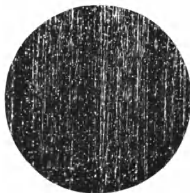
Abb. 101/2. (L 7) Gute Meßklotzfläche, feine Strichpolitur. Vergr. 100 \times . J = 5,5 , G = 18 .
