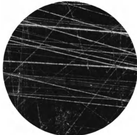
Abb. 46/4. Stahl poliert, mit Epilampe von oben beleuchtet. Vergr. 71×. Einfluß des Azimutes.
