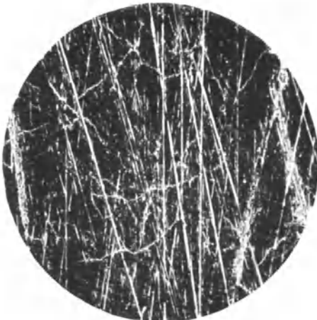
Abb. 55a. Gußeisen; Os ; V = 170\times .
