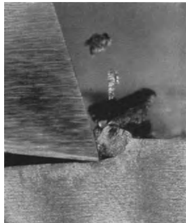
Abb. 137/2. Scherspan mit Einreißen vor der Schneide. Messing. v = 21,7 m/min; t = 1,2 mm/Uml.; \gamma = 15^\circ . Vergr. 3\times .
