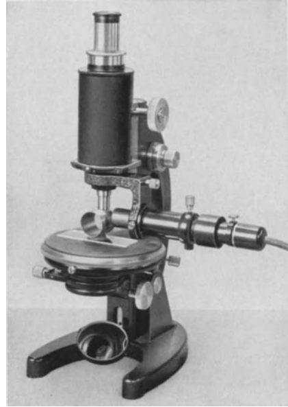
Abb. 76/2. Zusatzgerät zum gewöhnlichen Mikroskop zur Untersuchung von Oberflächen nach dem Lichtschnittverfahren.
