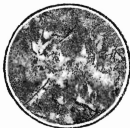
Рис. 2. Шлиф чугуна с поверхностью, травленной спиртовым раствором пикриновой кислоты
