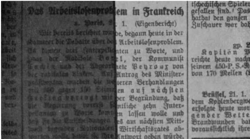
Abb. 127. Übertragungsprobe mit Argon-Stickstoff-Schreibglimmlampe. Linke Hälfte Glas-, rechte Quarzoptik. Schreibgeschwindigkeit 100 cm/s, Glimmstrom 5 mA.
