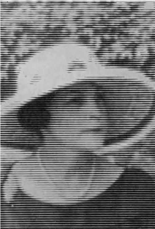
Abb. 134. Bild variabler Zeilenbreite.
