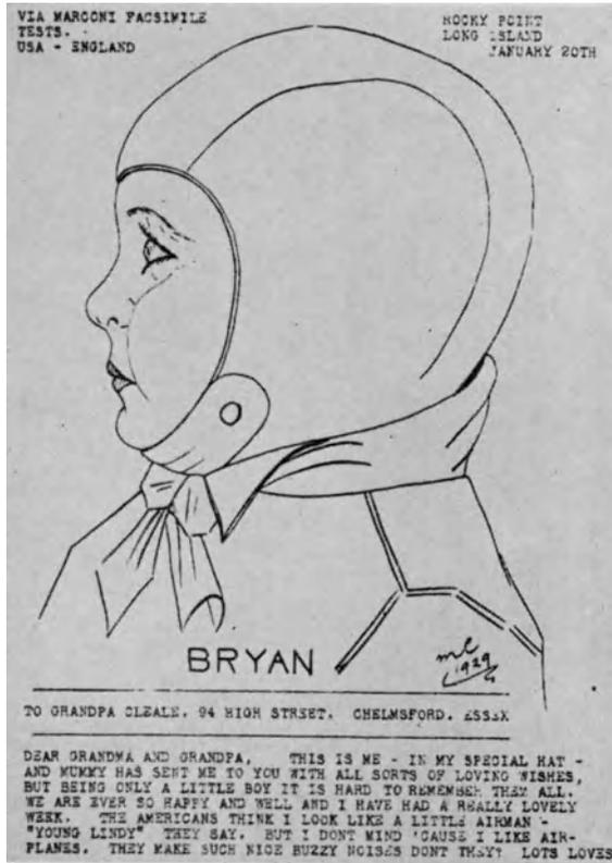
Abb. 326. Bildübertragung mit dem Marconi-Gerät, Rocky Point—Somerton, 1928. 4 Linien/mm, 2,7 min/dm<sup>2</sup>.
