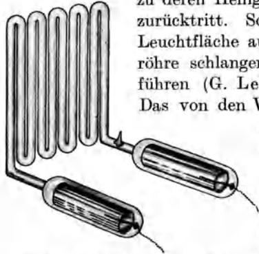
Abb. 155. Flächenglimmlampe mit schlangenförmiger Leuchtröhre.
