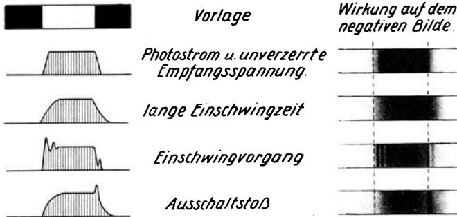
Abb. 198. Durch Einschwingvorgänge im Verstärker verursachte Bildfehler.
