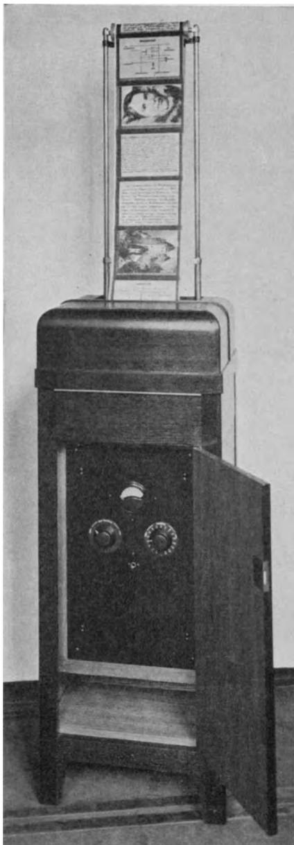
Abb. 305. Vollständiger Bandchemograph von Siemens & Halske.
