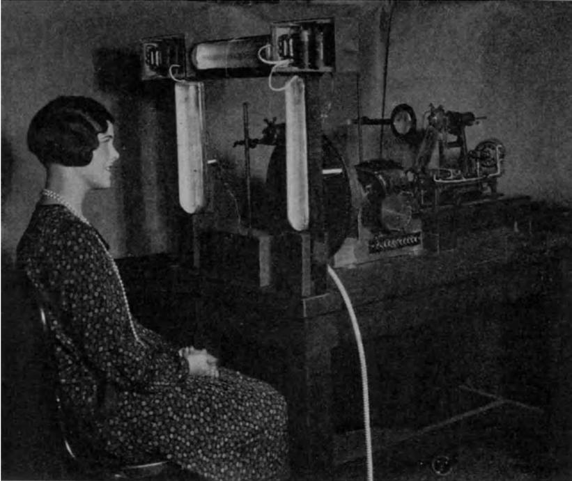
Abb. 351. Fernsehsender für Personenabtastung. (Mit freundlicher Genehmigung des Bell-Laboratoriums.) Man beachte die drei großen zylindrischen Photozellen.
