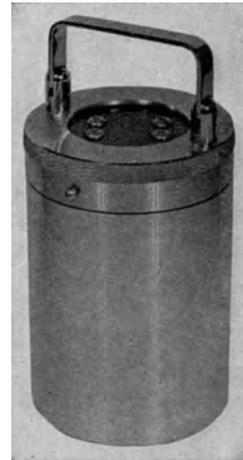
Abb. 174 b. Stimmgabel für 1560 Hz in druckdichtem Gehäuse.
