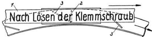
Abb. 333. Faksimile-Streifentelegraph. Prinzip der Zerlegung mit Zeilensprung. 1 Telegrammstreifen. 2 Lichtschlitz. 3 Schrägspalt.
