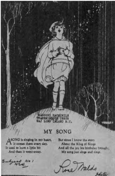
Abb. 325. Bildübertragung mit dem Marconi-Gerät, Rocky Point—Somerton, 1928. 4 Linien/mm, 53 s/dm<sup>2</sup>.
