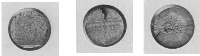
a) Schlag stets auf die gleiche Stelle; b) Schlag abwechselnd an 2 Stellen, um 180° versetzt; c) an 25 um je 14,4° versetzten Stellen.
