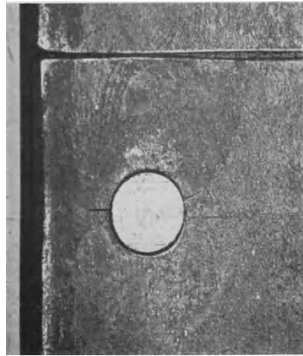
Abb. 119. Blech aus einer Nietverbindung, die oftmals belastet und entlastet worden war. Rechts und links von der Lochwand ausgehend Riß im Blech.
