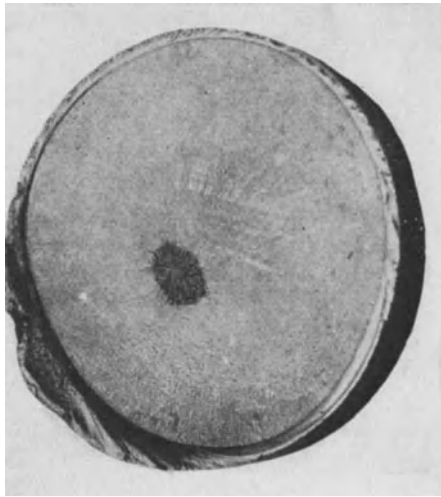
Abb. 43. Dauerbruch mit Fehlstelle. Bruch von innen ausgehend.
