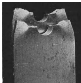
Abb. 71. 82 000 Belastungen mit \sigma = 0 bis 3100 \text{ kg/cm}^2 . (Stab II 11 aus den Versuchen von Föppl 2 .)
