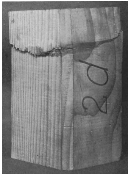
Abb. 160. Holzprismen nach oftmaliger Druckbelastung.
