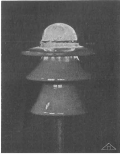
Abb. 19. Glimm- und Gleitentladungen am Kopf eines Isolators bei der Trockenprüfung.
