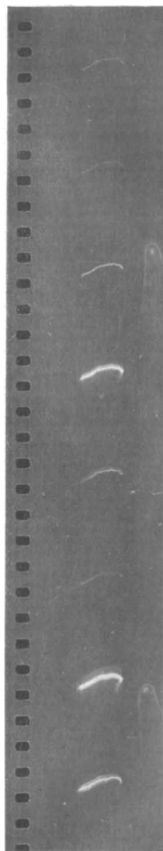
Abb. 7. Weitere Ausbreitung des Flamm bogens.
