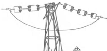
Abb. 42. Abspannmast mit Schäkel- (Abspann-)isolatoren.
