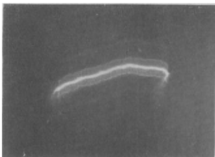
Abb. 8. Beginn der Funkenentladung. Dauer \frac{1}{500} Sek. 4 malige Vergrößerung des Filmbildes.
