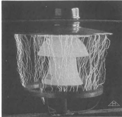
Abb. 37. Metallschirmisolator mit Schutzring als Sicherheitsfunkenstrecke wirkend.
