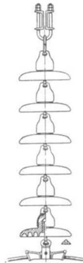
Abb. 49. 6gliedrige Kappenisolatorenkette für 110 kV.-Betriebsspannung
