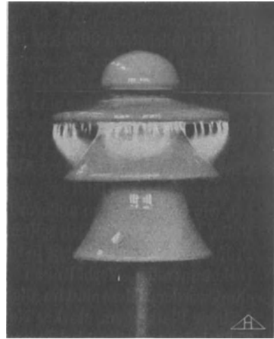
Abb. 20. Von den Regentropfen ausgehende Büschelentladungen nach kurzzeitiger Beregnung.
