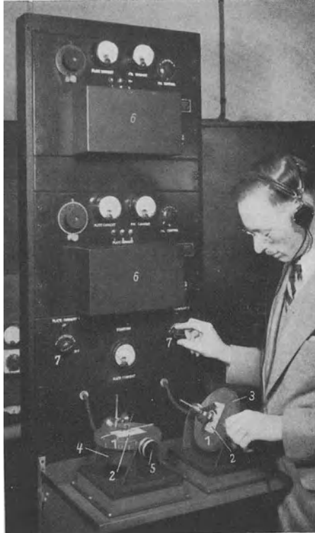
Abb. 314. Akustische Zeitwaage der Bell Telephone Laboratories. (Aus PFLLER: Zeitwaagen. Arch. techn. Messen J 154—9.)
