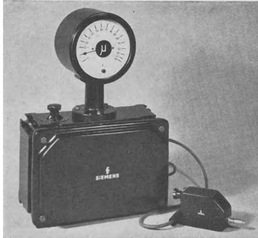
Abb. 122. Bolometrische Meßlehre mit Schaltkasten für Steuerungen. [Aus MERZ-NIEPEL: Messung kleiner Ströme und Spannungen und kleiner Längenänderungen mit dem bolometrischen Kompensator. Wiss. Veröff. Siemens-Werke Bd. 18 (1939) S. 158.]
