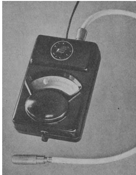
Abb. 139. Röntgen-Wanddickenmesser mit Ionisationskammer und elektrostatischem Lichtzeigerinstrument (Ausführung Siemens & Halske A.G.).
