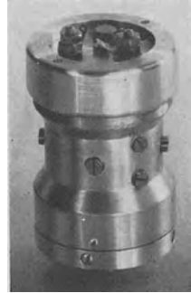
Abb. 235. Kohledruck-Beschleunigungsmesser nach MERZ-NIEPEL (Ausführung Siemens & Halske AG.)
