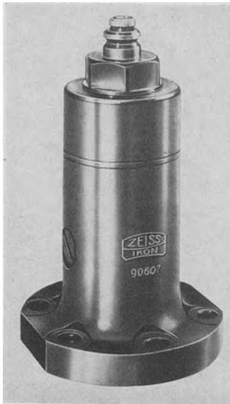
Abb. 244. Ansicht des piezoelektrischen Beschleunigungsmessers der Zeiss-Ikon A. G. Meßbereich 5 \cdots 10000 g; Empfindlichkeit 10^{-14} Coul·cm ^{-1} s ^2 ; Eigenfrequenz \approx 24 kHz; Dämpfungsgrad \alpha = 0,03 .
