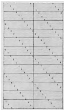
Abb. 320. Diagramm einer richtiggehenden Uhr mit 20944 Schlägen/h, aufgenommen mit dem Watch-Rate Recorder. (Aus PFLIER: Zeitwaagen. Arch. techn. Messen J 154—9.)
