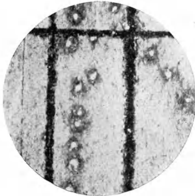
Abb. 281. Mikrophotographie von Funkenmarken auf Wachs Papier. [Aus MARRISON: The spark chronograph. Bell Labor. Rec. Bd. 18 (1939) S. 55.]
