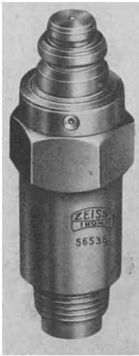
Abb. 211. Ansicht des Piezodruckelements für Verbrennungsmotoren (Ausführung der Zeiss-Ikon A. G.).
