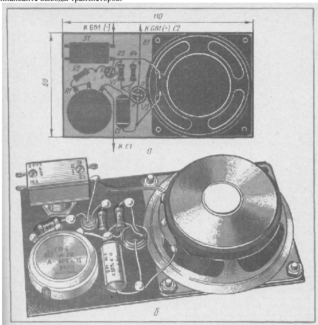
Рис. 115. Монтажная плата электромузыкального инструмента: а — расположение деталей; б — внешний вид смонтированной платы
