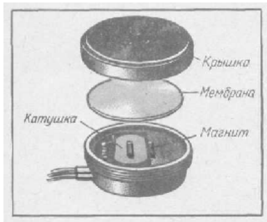
Рис. 140. Устройство капсуля головных телефонов
