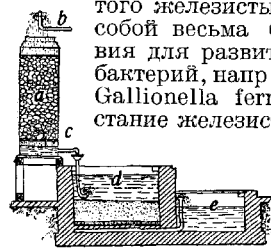
Рис. 1. Схема установки для деферризации по методу Пифке: а — градириная; б — сито (распределитель); в — дренаж; г — фильтр; е — резервуар очищенной воды.
