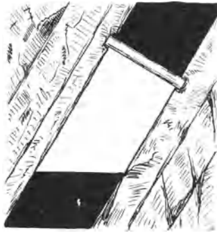
Fig. 315. Stempelzimmerung auf steil einfallender Lagerstätte.
