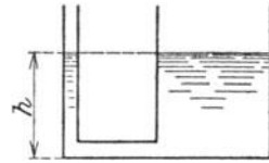
Abb. 39. Verbundene Gefäße; h Flüssigkeitsstand in beiden Räumen
