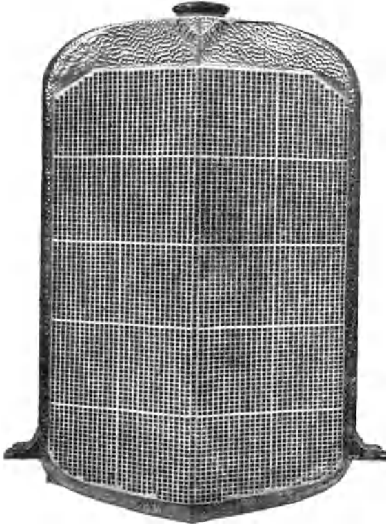
Abb. 101. Kühler (ausgeführt von der Windhoff A.-G. Berlin) mit geraden wag- und senkrechten Wasserkanälen, meist als sogenannter Bienenkorbkühler bezeichnet; oben die Einfüllöffnung, unten links und rechts die Pratzen zur Befestigung am Wagenrahmen
